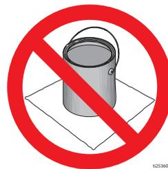
**Reliez toujours un seau métallique à la terre :** raccordez un fil de terre au seau. Serrez une extrémité au seau et l'autre extrémité à une vraie prise de terre telle qu'un conduit d'eau.
