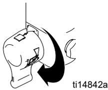
11. Démontez les filtres du pistolet et du pulvérisateur, si existants. Nettoyez et inspectez. Remontez les filtres.
