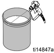
9. Relevez le tube d'aspiration au-dessus du niveau de liquide de rinçage et faites fonctionner le pulvérisateur pendant 15 à 30 secondes pour vidanger le produit. Mettez la pompe et le moteur sur ARRÊT
